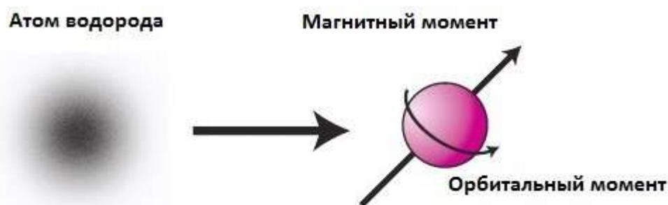
После взаимодействия радиоволны с протонами и резонансного усиления колебаний, частицы снова стремятся прийти к равновесному состоянию, при этом, излучая фотоны (из которых и состоит радиоволна). Это и называется эффектом ядерного магнитного резонанса [9]. Энергия излучения резонансного эффекта принимается чувствительными датчиками и, после усиления, информация передается на компьютер, где будет отображена картина исследуемого объекта.
